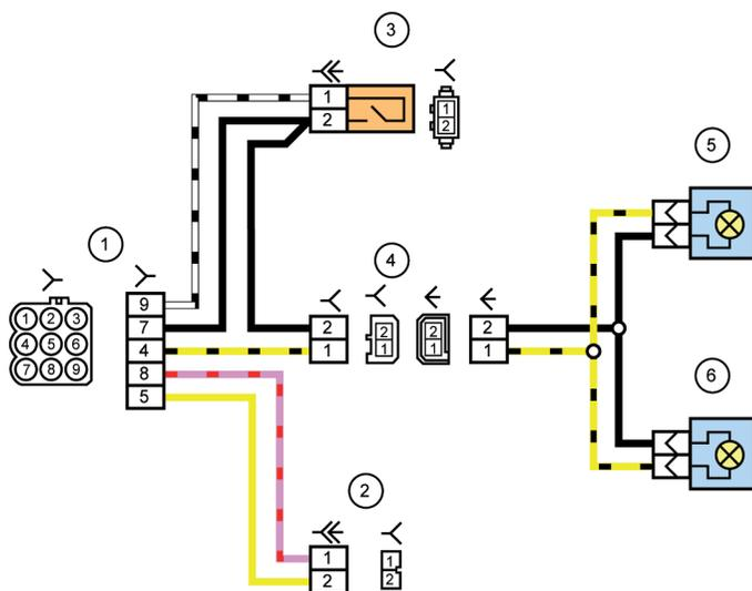
Жгут проводов задний дополнительный левый (жгут проводов крышки багажника) - 1118-3724558.
