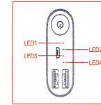
Подключите Mi адаптер к блоку питания, чтобы зарядить его. Во время зарядки, индикаторы состояния отображают уровень заряда следующим образом:
